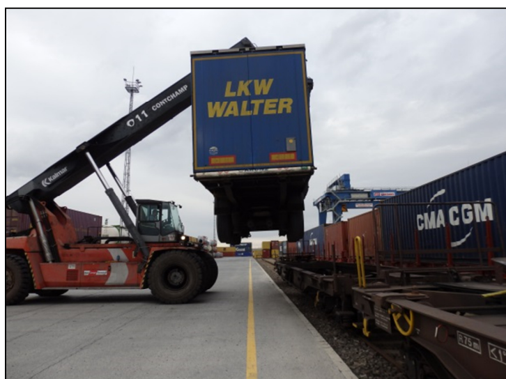
2. ábra. Daruzható félpótkocsi vagonba emelése
